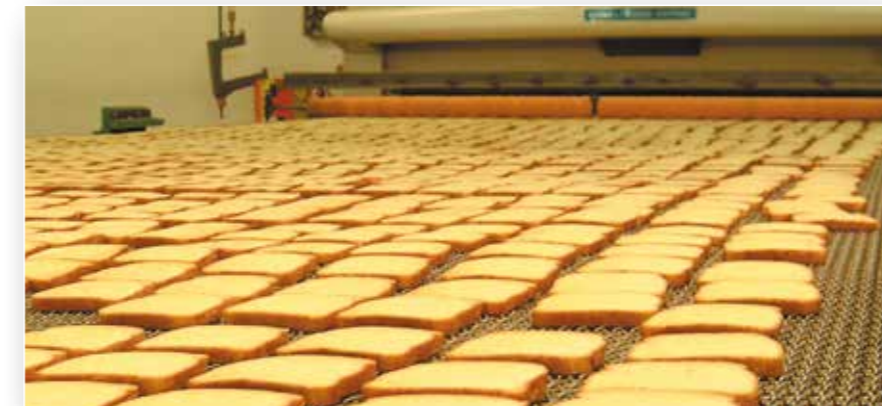
Banda en espiral wirelink en un horno, en Bolleleje, Almelo, Holanda.
