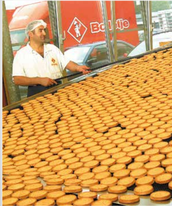
Las bandas metálicas son muy adecuadas tanto para el transporte de productos ligeros como pesados.
